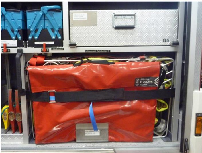
Für den Erstangriff stehen im G5 beider HLF jetzt **Rollschlauchtragekörbe** bereit.
