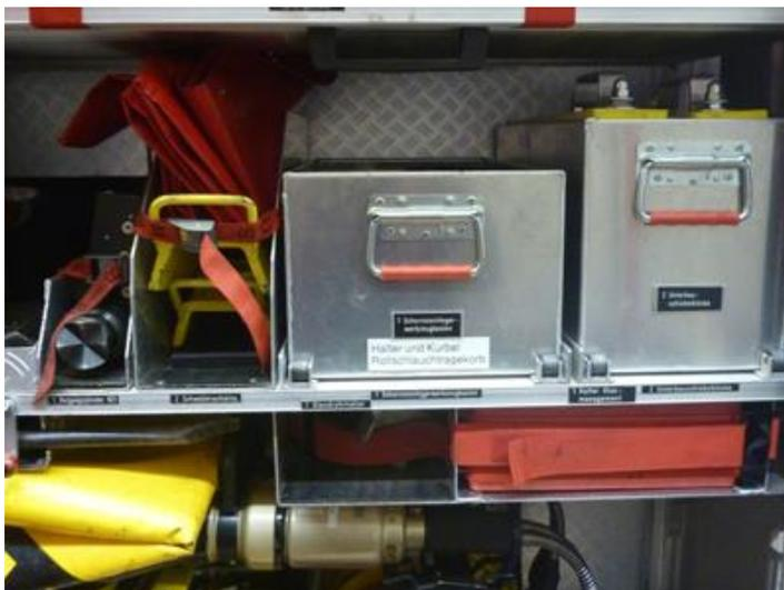
**Halter und Kurbel** für die Rollschlauchtragekörbe sind im HLF20-1 direkt über den Körben, im HLF20-2 im Geräteraum G1 untergebracht.
