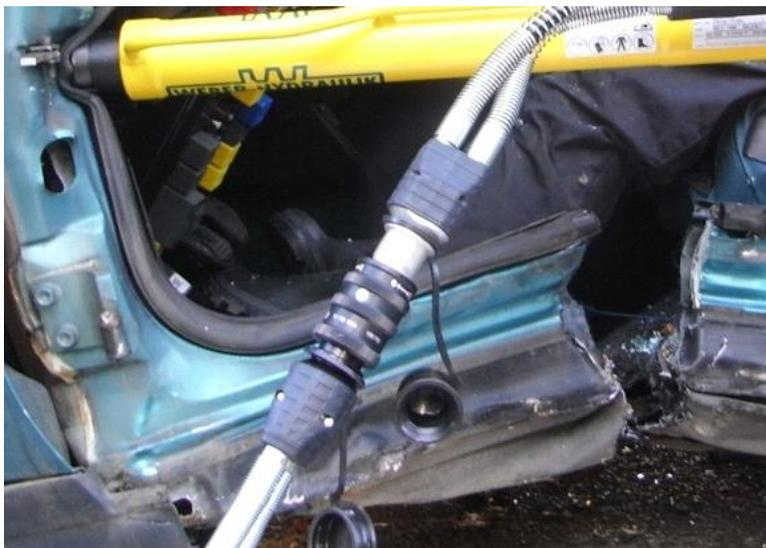
Seit 13.04.2013 sind alle hydraulischen Rettungsgeräte der Abteilung Ditzingen auf **SINGLE-Kupplungen** umgerüstet. Dabei bleibt das Zweischlauchsystem zwar erhalten, das Arbeitsgerät ist aber nur mit einer, einfach zu bedienenden Kupplung an das Schlauchsystem angeschlossen. (alle Fahrzeuge mit H-Satz).
