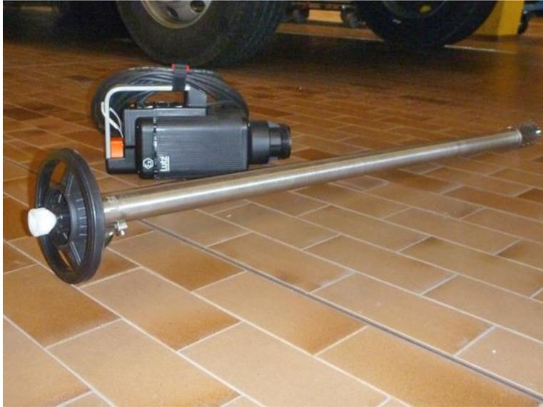
Elektrische „**Fassungspumpe Niro 41 Ex**“ für brennbare und leichtentzündliche Flüssigkeiten (RW).
